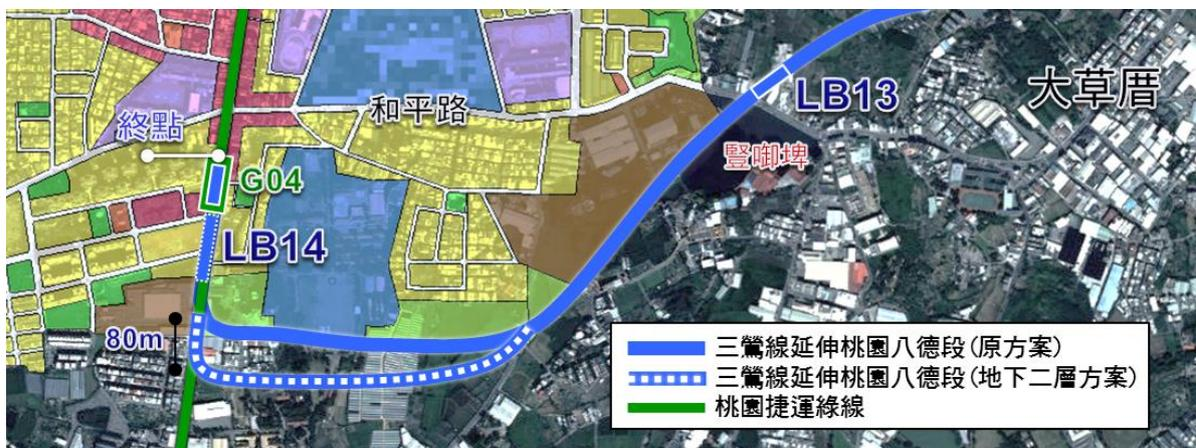
圖 5 三鶯線延伸段配合 LB14 站減層方案(地下二層)調整線形示意圖
