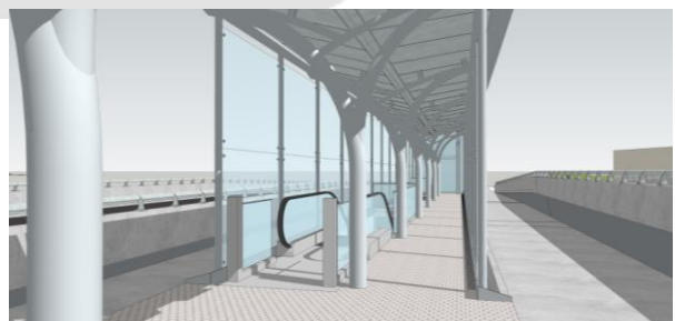
圖 19 K2 站島式月台通廊區玻璃帷幕立面
