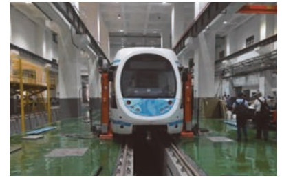
圖 32 U型機坑軌道
