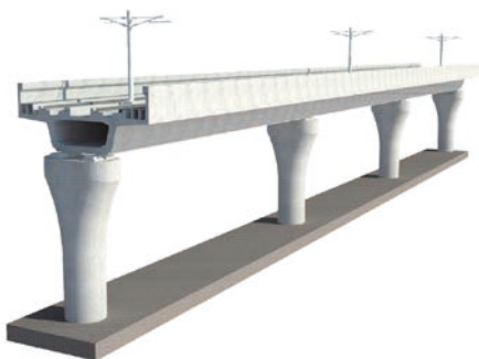
圖 18 制式橋—箱型梁橋透視圖
