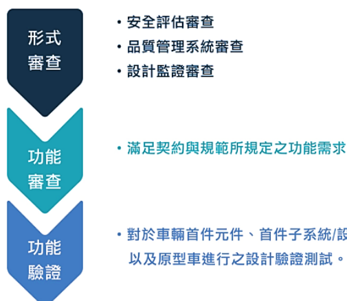
圖 11 車輛設計審查、監造與驗證作業概念示意
